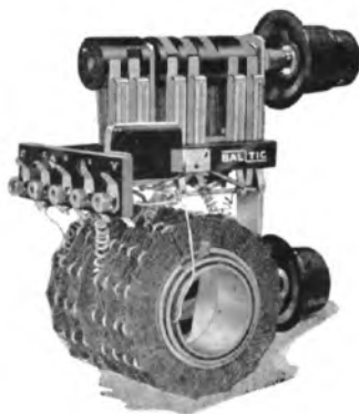
Baltic afgeschermde spoelenheid, waarvan de verhouding door een schakelaar (zoowel primair als secundair) in drie trappen variabel is. De eenheid bestrijkt bij een parallel-capaciteit van max. 500 cM. het geheele golfbereik en maakt dus uitwisseling van spoelen overbodig. De eenheid wordt naar verkiezing met of zonder variabele terugkoppelspoel geleverd en is dus bruikbaar voor alle doeleinden
