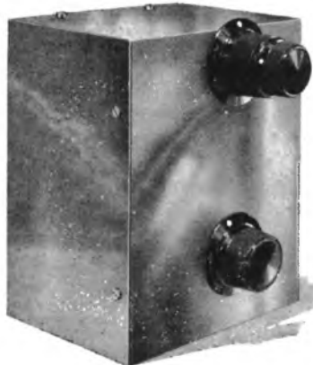
Baltic afgeschermde spoelenheid, waarvan de verhouding door een schakelaar (zoowel primair als secundair) in drie trappen variabel is. De eenheid bestrijkt bij een parallel-capaciteit van max. 500 cM. het geheele golfbereik en maakt dus uitwisseling van spoelen overbodig. De eenheid wordt naar verkiezing met of zonder variabele terugkoppelspoel geleverd en is dus bruikbaar voor alle doeleinden
